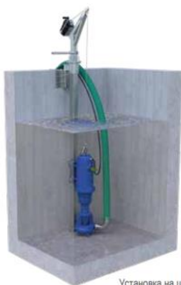
Установка на штанге
